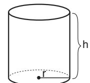
**Площадь боковой поверхности** цилиндра, радиус основания которого равен  $r$ , а высота  $h$ , равна произведению периметра основания на высоту цилиндра, то есть  $2\pi r \cdot h$ .
