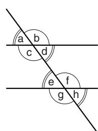
**Внутренние накрест лежащие углы** располагаются на противоположных сторонах параллельных прямых с противоположных сторон пересекающей их прямой. Внутренние накрест лежащие углы также равны между собой. Поэтому, на чертеже:  $a = h$ ,  $b = g$ ,  $c = f$  и  $d = e$ .
